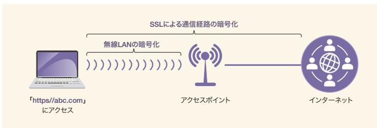
図7-4 SSLによる暗号化
